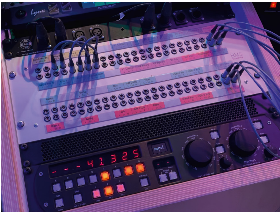
Bild 7: Das Bild zeigt das Lemo-Steckfeld und den Hermes Routing Switcher im verlagseigenen Mastering-Studio
