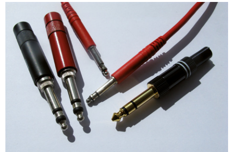
Bild 3: A- und B-Gauge-Klinken im Größenvergleich oder auch Bantam bezeichneten Klinken und die B-Gauge Klinken, die früher in Telefonzentralen zum Einsatz kamen. Bei den B-Gauge Klinken handelt es sich um 6,3 mm Klinken, allerdings in professioneller Ausführung. Die TT-Klinken (TT = Tiny Telephone) oder auch A-Gauge sind im Prinzip miniaturisierte Ausführungen der größeren Version.
