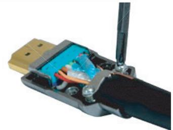
4.4 Montieren Sie die obere Hälfte der Metallschale mit den zugehörigen Schrauben. Achten Sie bitte darauf, dass die Gewindelöcher frei liegen.
