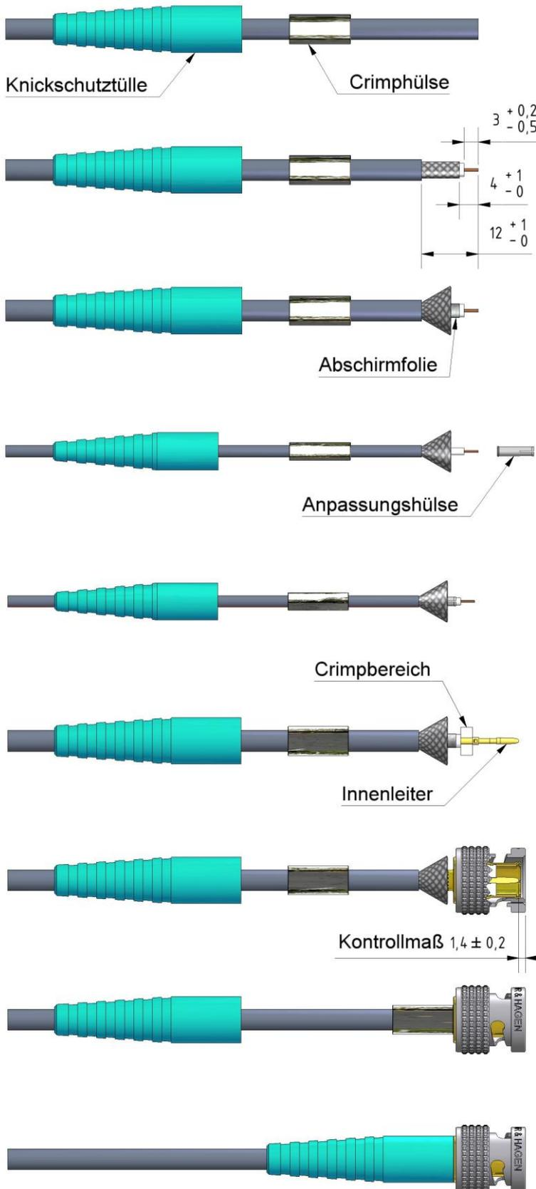
Knickschutzhülse und Crimphülse auf das Kabel schieben.
